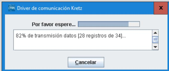
6. Para finalizar el proceso de cambio de modelo de datos hacer clic en **Salir**. De esta manera la balanza queda configurada para recibir PLUs con códigos de más de 5 Dígitos. Para realizar una prueba se puede crear artículos en iTegra con códigos de 6 o + dígitos, transmitirlos, y al finalizar llamar al artículo mediante los dígitos correspondientes a su código.
