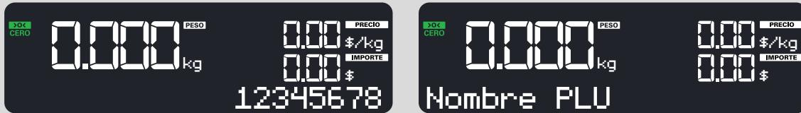
En el ejemplo la balanza permite buscar el PLU mediante los 6 dígitos de código. Para realizar una prueba se puede crear artículos en iTegra con códigos de 6 o + dígitos, transmitirlos, y al finalizar llamar al artículo mediante los dígitos correspondientes a su código.
