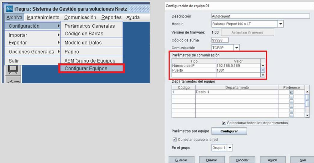
Presionar Guardar. Finalizado este procedimiento la balanza hará un Beep indicando que fue conectada exitosamente.
