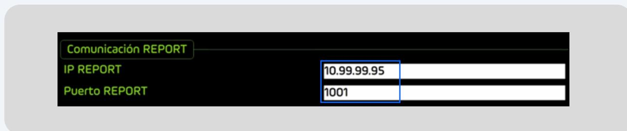
Esta IP es la que se debe colocar en la balanza para que se pueda comunicar con la AutoReport, este proceso está detallado en el paso siguiente.
