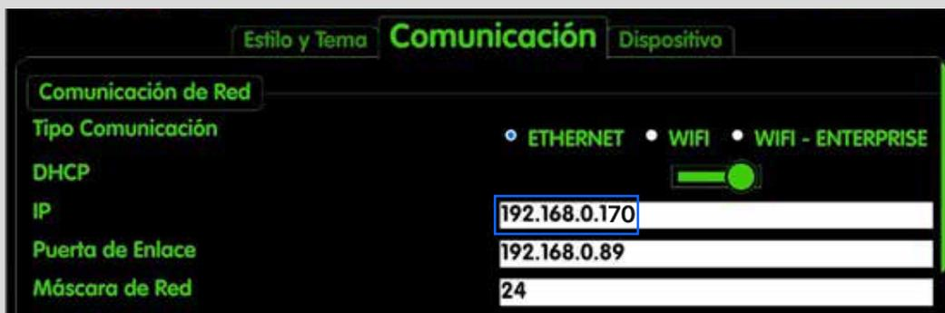
4. Ingresar desde la Computadora al Sistema iTegra. Ingresar a la pantalla de Archivo > Configuración > Configurar Equipo. Luego Ingresar a un Equipo para realizar la configuración de IP.
