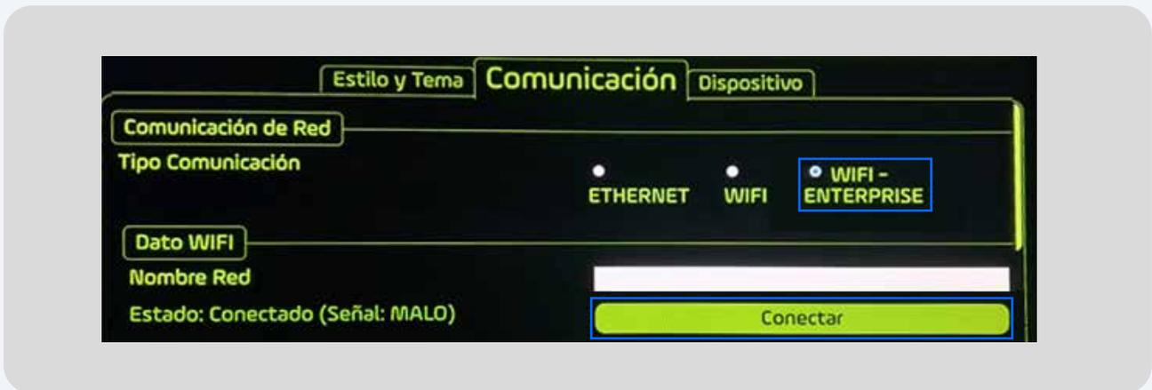
3. Colocar el Nombre, Usuario y la contraseña de la red donde está conectado el dispositivo donde se utiliza iTegra y presionar Aplicar.
