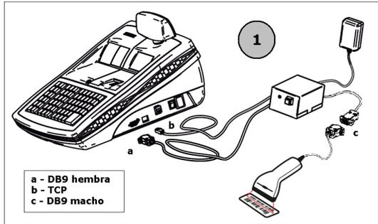
Conectar los conectores DB9 hembra y Ethernet a la Caja Registradora **Numa NG** y luego conectar **autoNuma** a la red eléctrica.
