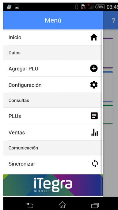
13. Luego de realizar la carga de un PLU, o cambiar alguna configuración se deben sincronizar los datos en la opción **Sincronizar** para efectuar los cambios en la balanza. La aplicación muestra la siguiente pantalla donde se muestra la sincronización de datos y luego la confirmación de la misma.
