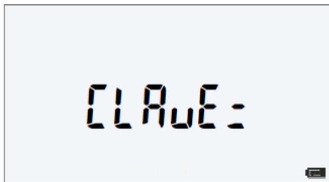
3. Ingresar la clave 99999 y luego presionar la tecla
